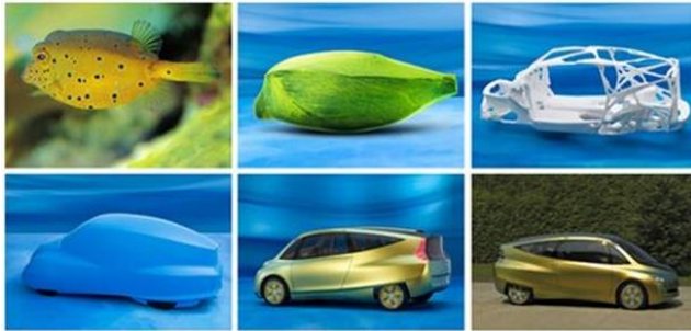
Figuur 4. De kogelvis als inspiratiebron voor de bionische auto van Mercedes-Benz
